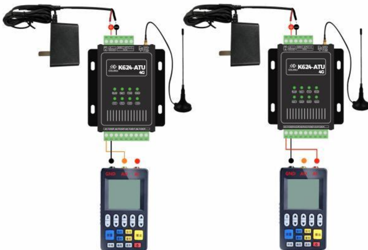
图 2-3 连接信号发生器工具（可以是传感器和万用表）
