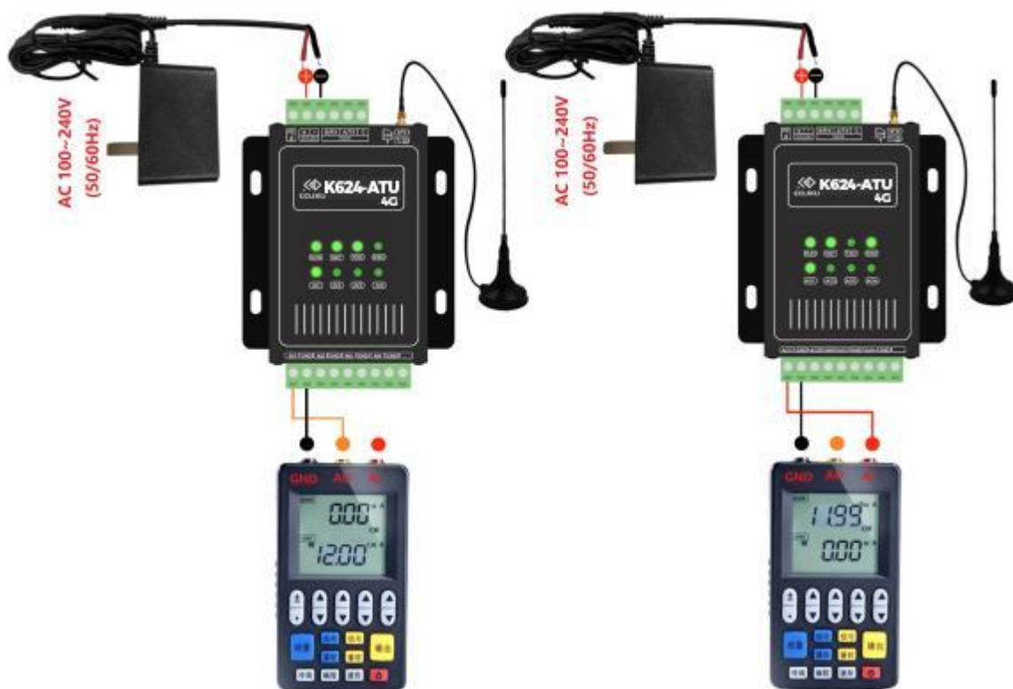
图 2-4 观察模拟量输入和输出模块的电流值
