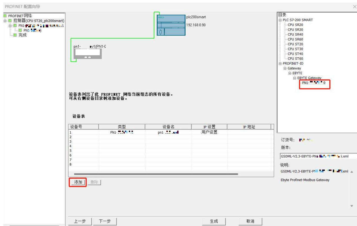
双击设备名栏，填入相应设备名称，同一项目内不能有相同的设备名，同样设置 IP 地址，保持和 PLC 控制器在同一网段内，最后点击生成。
