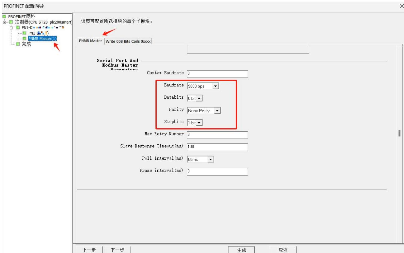
配置寄存器信息，用于 Profinet 网关与 RTU 通信；
