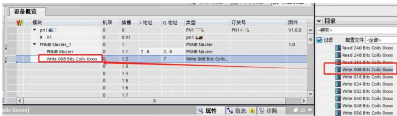
第四步：配置网关串口的工作参数，选择刚才添加的主机模块（PNMB Master），这里需要根据 RTU 工作的串口参数配置网关的串口参数
