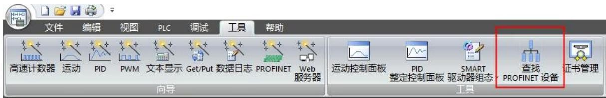
打开工具选择与网关连接的电脑网卡，选择网关配置“站名称”，如有多个模块，可通过闪烁指示灯定位需要配置的网关设备；
