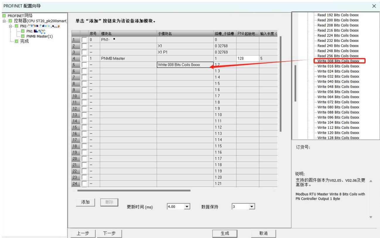
第四步：配置网关串口的工作参数，选择刚才添加的主机模块（PNMB Master），这里需要根据 RTU 工作的串口参数配置网关的串口参数
