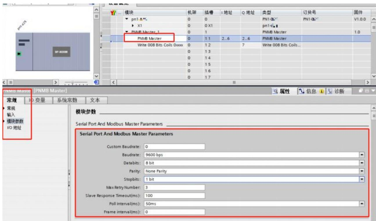
配置寄存器信息，用于 Profinet 网关与 RTU 通信；
