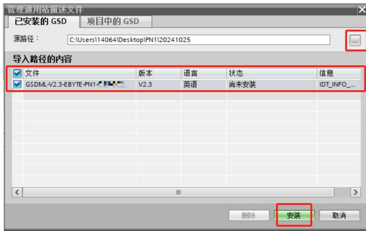
3. 安装完成后点击关闭即可，之后就可以进行设备组态了。
